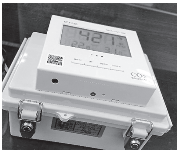
写真-5 CO 2 コントローラーおよび無線ノードが収納されたプラボックス（左）、Raspberry Piによって構築された無線ノード（右）
