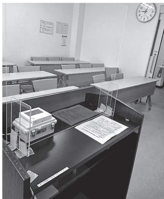
写真-6 工学部が管理する講義室のCO 2 センサノードの設置写真
